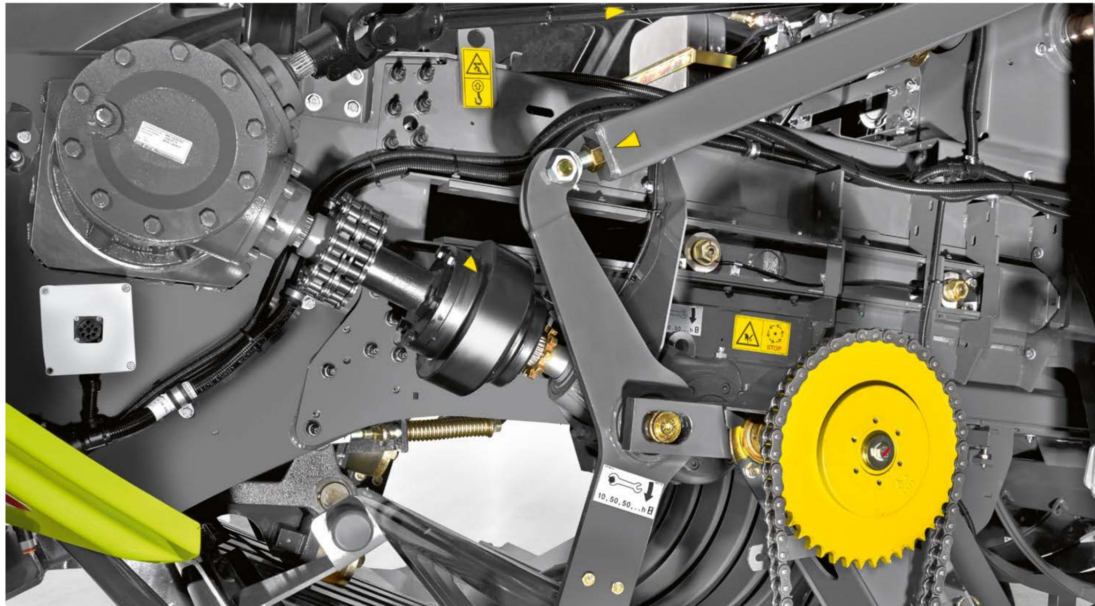
Поршень также защищен от перегрузки с помощью муфты отключения. Все предохранительные муфты после снижения частоты вращения вала отбора мощности снова автоматически входят в зацепление.
