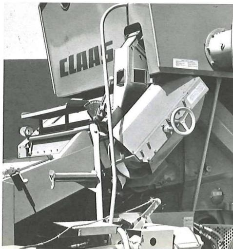
Neben der konstruktiven Ausführung von Trommel und Korb beeinflusst die richtig gewählte Drehzahl der Dreschtrommel den Ausdrusch entscheidend. Deshalb wird der CLAAS-GARANT serienmäßig mit einer stufenlosen mechanischen Drehzahlverstellung ausgerüstet. Auch die Drehzahl der Haspel kann mit einem Regeltrieb stufenlos verstellt werden.
