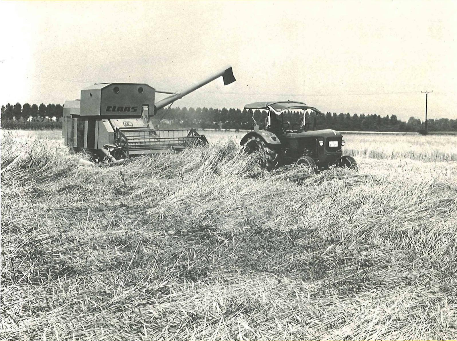
Der CLAAS-GARANT ist ein gezogener Mähdrescher in Längsfluß-Bauart. Seine Schnittbreite beträgt 2,40 m. Kraftbedarf: Schlepper ab 45 PS genügen. Die Leistungsfähigkeit des CLAAS-GARANT ist bemerkenswert. Das liegt an den besonders breiten Dreschorganen und an den großen Schüttler- und Siebflächen. Selbstverständlich wird auch diese Maschine zur Einmann-
